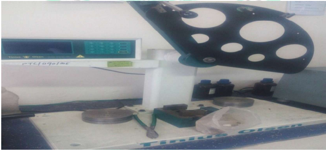
Fig. 4.27 Izod Impact Tester.
