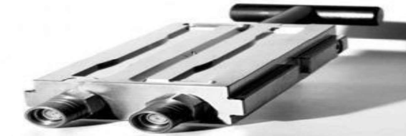
Fig. 4.21 Tensile Insert Mould.
