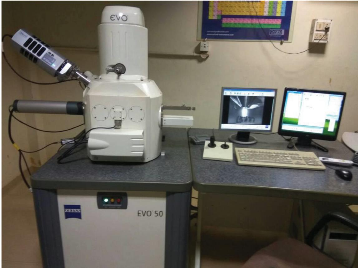
**Figure 4.7: CARL ZEISS EVO 50 SEM MACHINE
